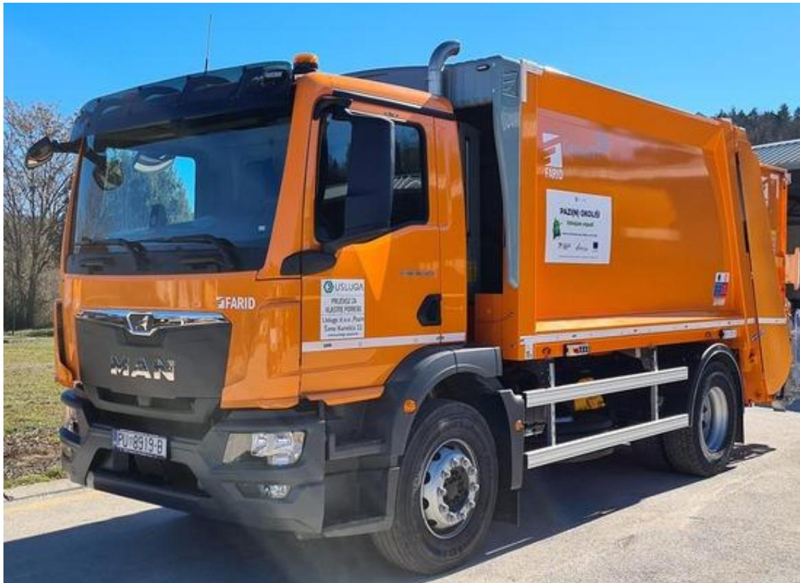
Slika 10. Specijalno komunalno vozilo od min.  $14 \text{ m}^3$  za odvojeno prikupljanje otpada [15]
