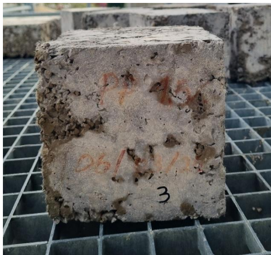
Slika 29: Beton s 1,50 % PP vlakana
