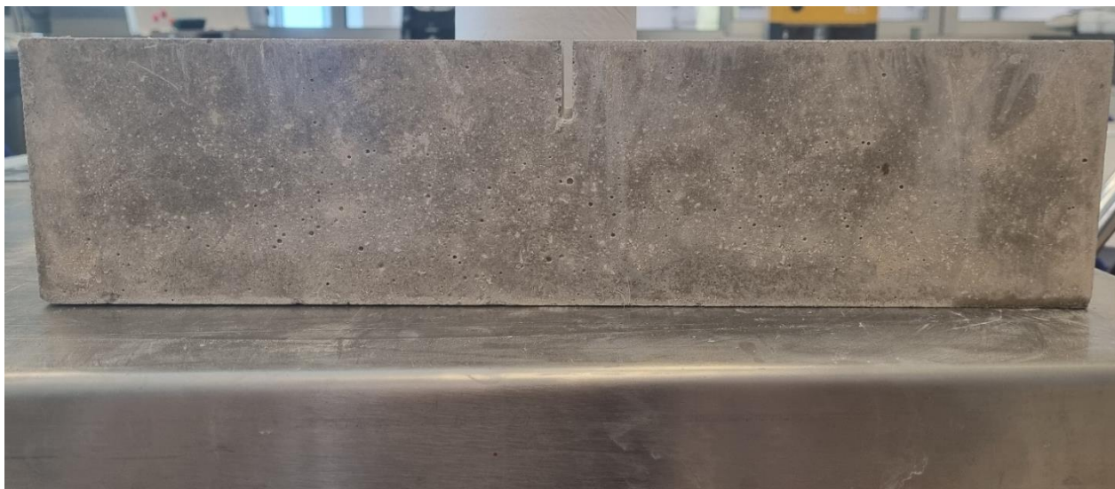
Slika 23: Oslabljenje presjeka prizme izvedbom zareza visine 25 mm
