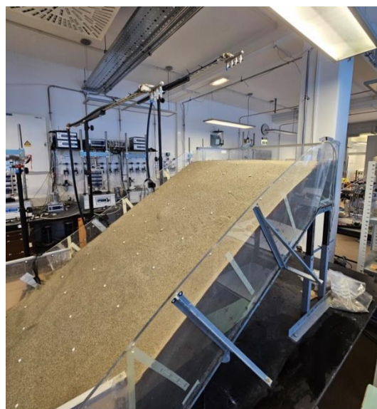
Slika 25: Fizički model kosine s nagibom od 35^\circ izrađen od uniformno graduiranog sitnog pijeska iznad sloja šljunka debljine 5 cm za poboljšanje drenažnih svojstava tijekom ispitivanja [fotografirao autor]
