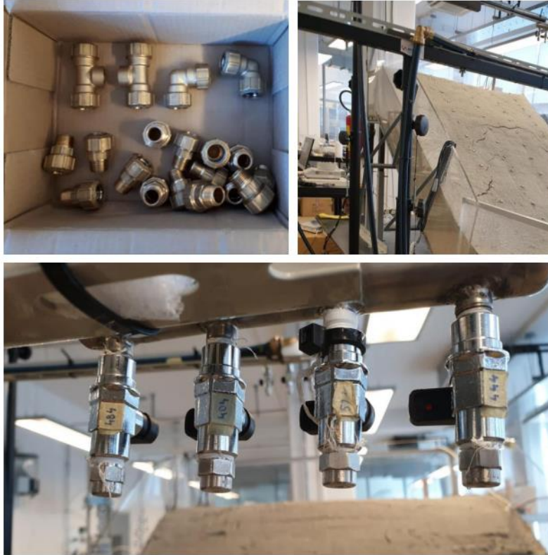
Slika 31: Detalji spojeva i elemenata, koji se koriste za spajanje PEHD cijevi simulatora oborina [5]
