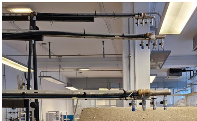
Slika 29: Elementi simulatora oborina: nosač mlaznica s ventilima, spojeni na horizontalnu granu simulatora [fotografirao autor]
