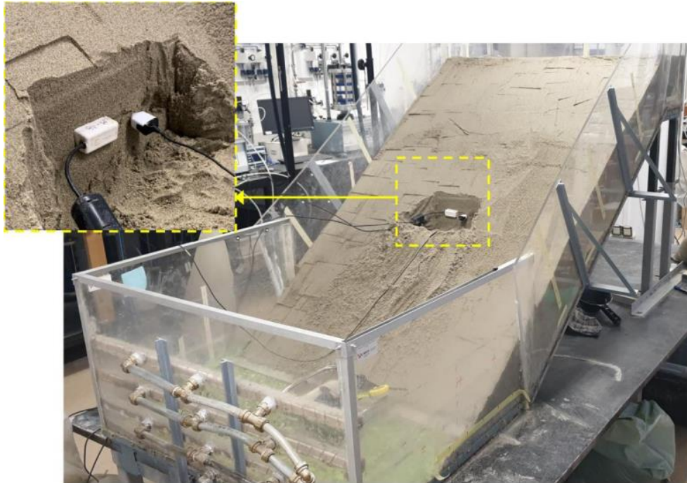
Slika 36: Detalj instalacije senzora vlažnosti tla TEROS 10 i mini-tenziometra TEROS 31 na promatranoj točki I 1 -6 [9]
