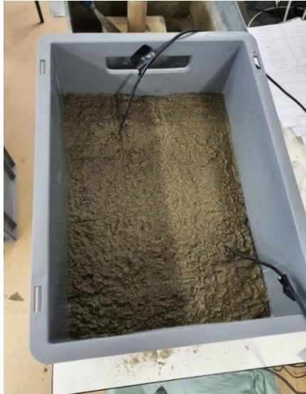
Slika 15: Prikaz uzorka pri saturaciji S=75\%
