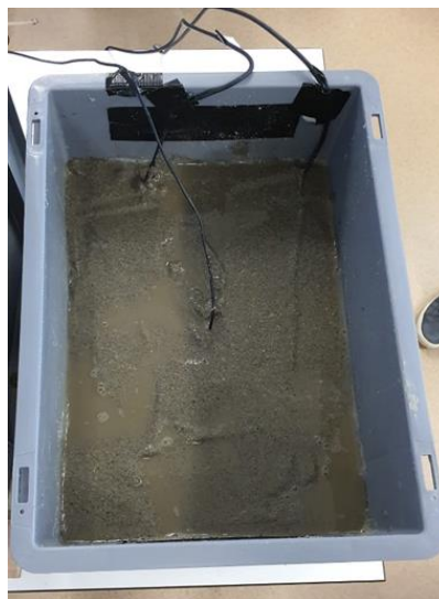
Slika 16: Prikaz uzorka pri proračunskoj saturaciji S=85\%
