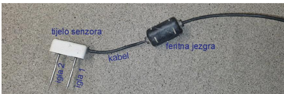
Slika 2: Dijelovi senzora TEROS 10
