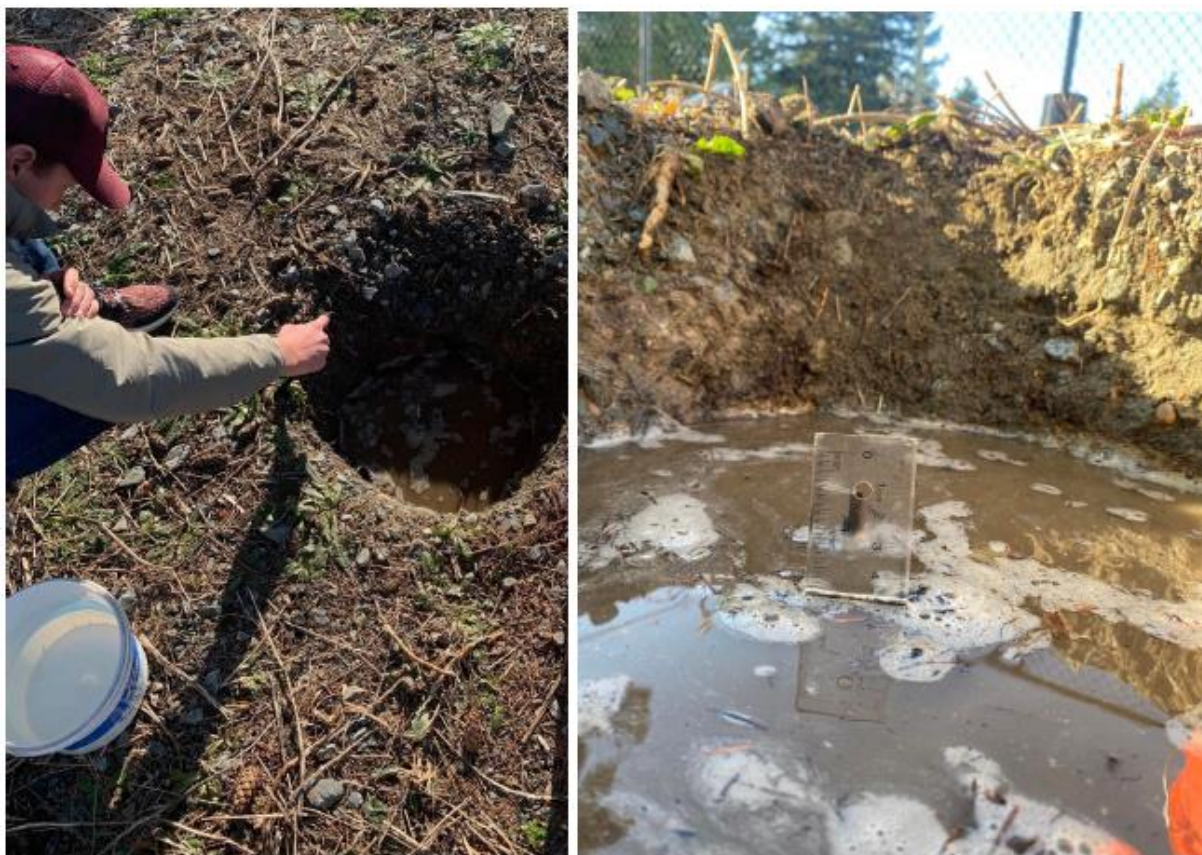
Slika 3: Primjer provedbe terenskih mjerenja stope infiltracije [4].
