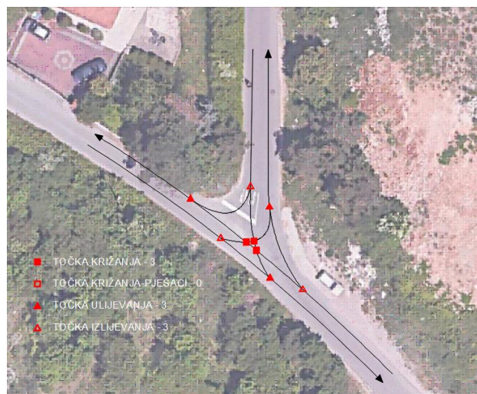
Slika 11. Konfliktne točke na postojećem raskrižju B
