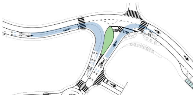
Slika 42 - R1 Varijanta 1 - Ispitivanje provoznosti prilikom skretanja TTV udesno sa glavnog na sporedni smjer i prilikom skretanja TTV udesno sa sporednog na glavni smjer
