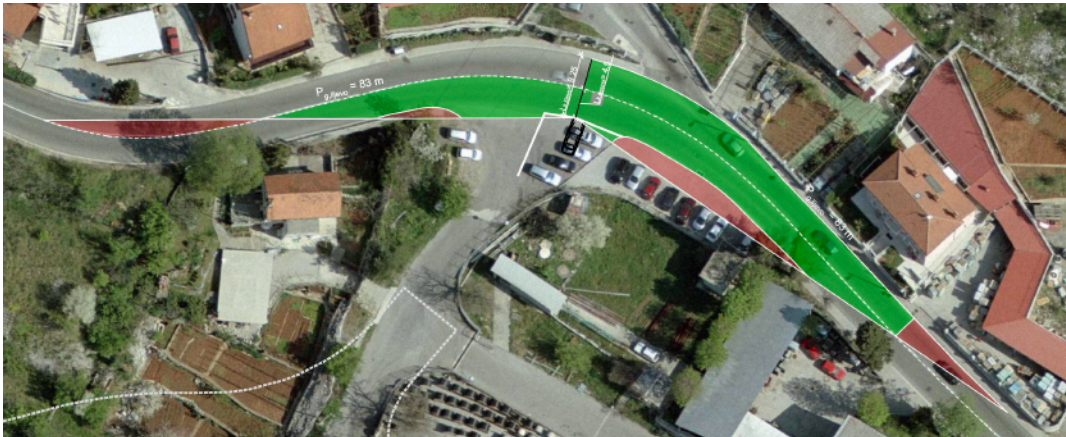
Slika 17 - Grafički prikaz zaustavne preglednosti prilikom skretanja ulijevo sa sporednog smjera prema HR modelu
