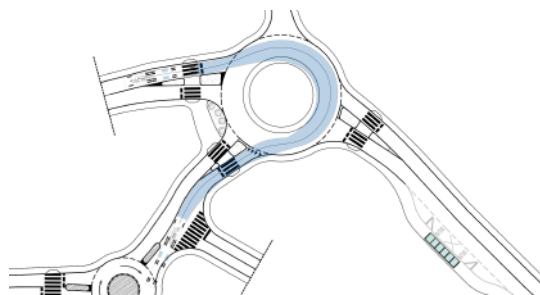
Slika 66 - R1 Varijanta 2 - Ispitivanje provoznosti prilikom skretanja ulijevo sa sporednog na glavni smjer
