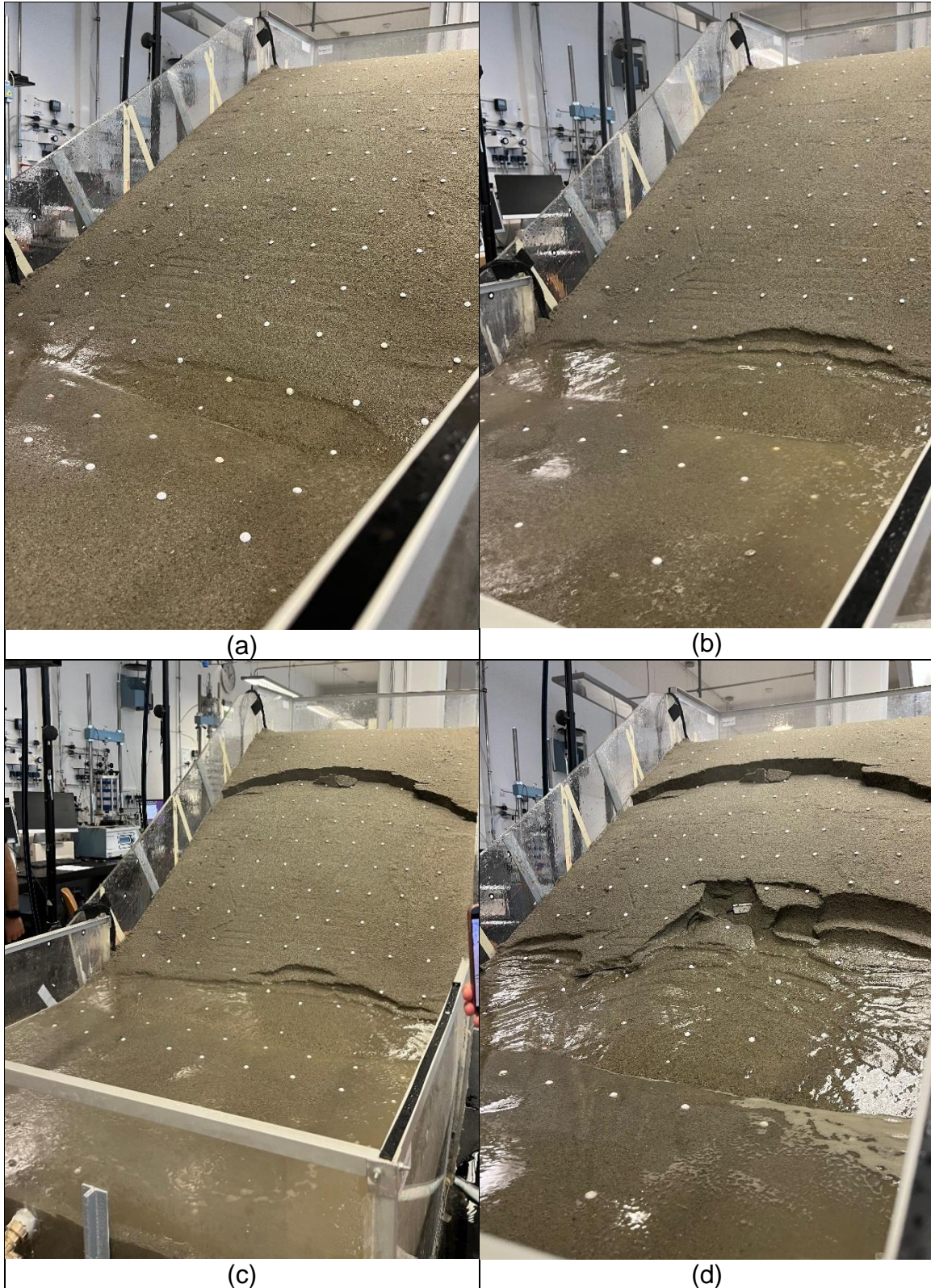
Slika 22: Prikaz napredovanja sloma; (a) 74.minuta ispitivanja; (b) 78. minuta ispitivanja; (c) 79. minuta ispitivanja; (d) 101. minuta ispitivanja
