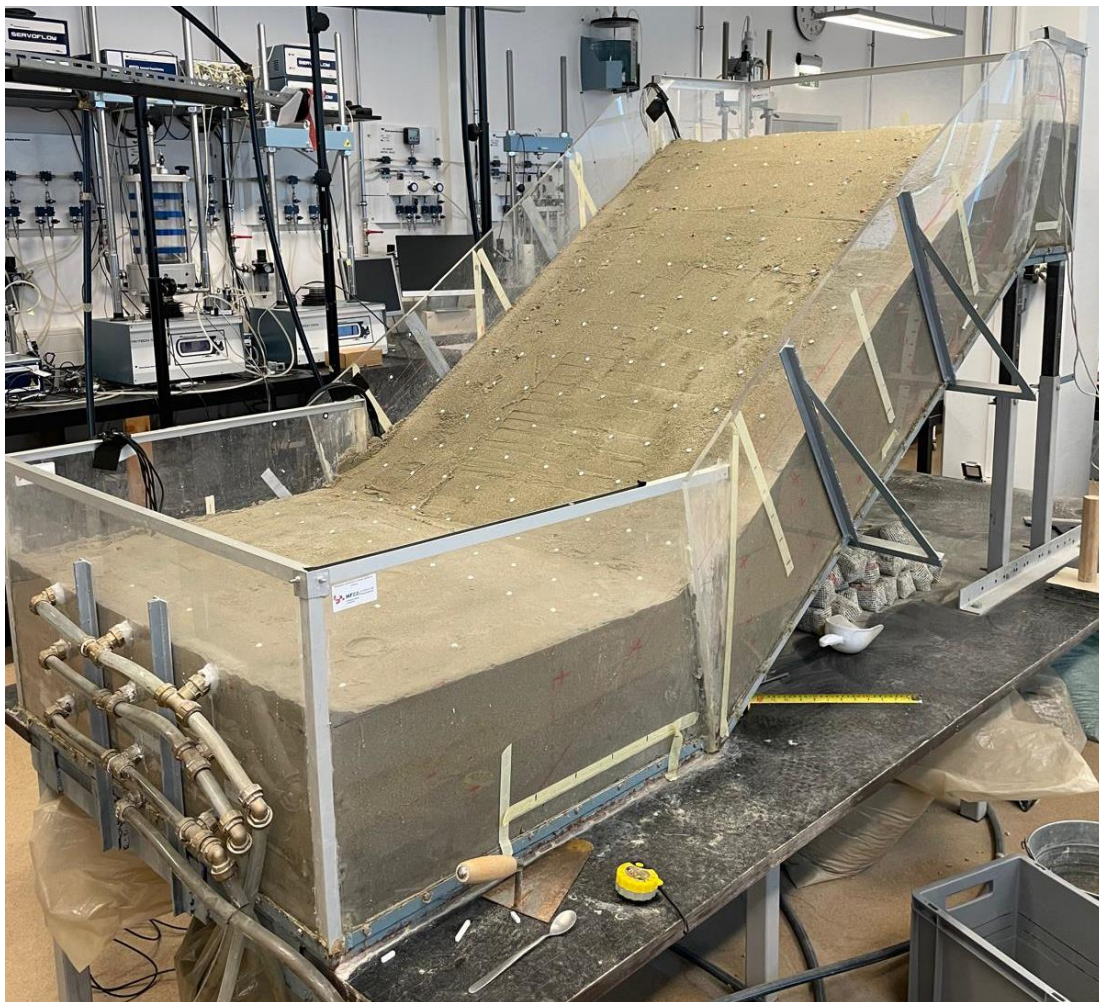
Slika 13. Model kosine s nagibom od 35 stupnjeva izgrađen od čistog, jednoliko granuliranog, finog pijeska na početku ispitivanja
