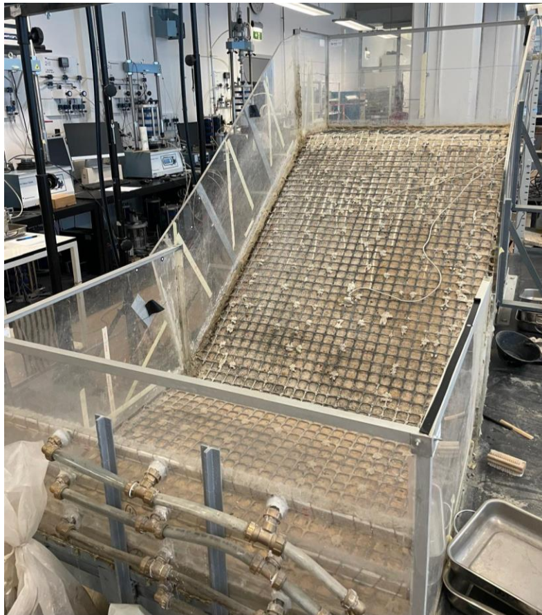
Slika 12. Prazan model pripremljen za izradu pokusa s geomrežom pričvršćenom na donje čelične ploče i drenažnim elementima u donjem dijelu modela
