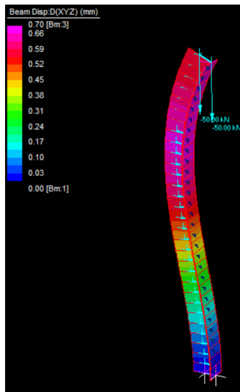
Slika 23 Vertikalni pomak prilikom linearnoga proračuna uslijed djelovanja ekscentrične rezultantne sile od 100 kN i zagrijavanja
