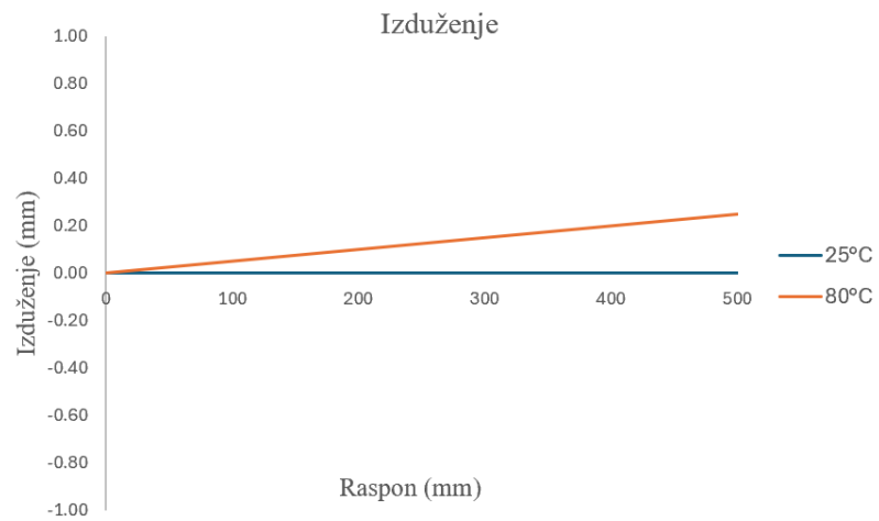
Slika 67: Izduženje (horizontalni pomak) slojeva 1 i 2 uzrokovan promjenom temperature
