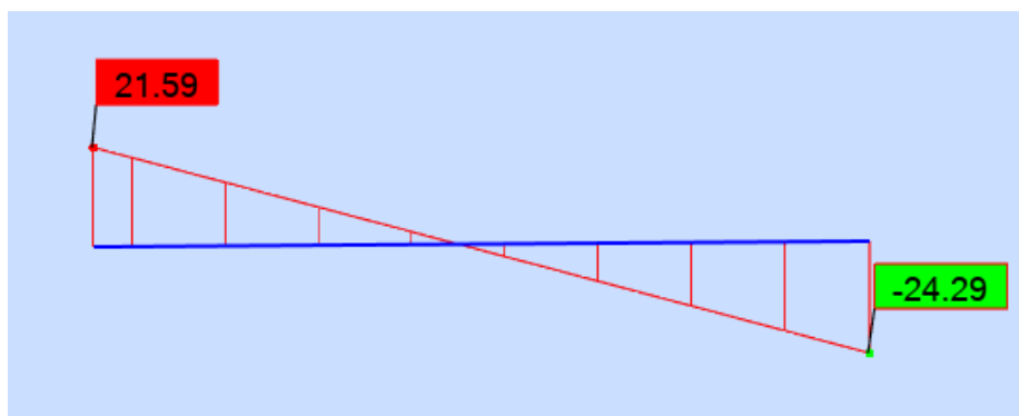
Slika 26. Vrijednost poprečne sile V_z za kombinaciju 12 (podrožnica)
