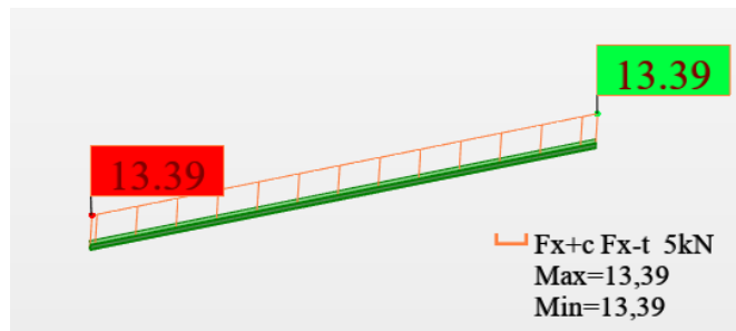
Slika 40: Dijagram uzdužnih sila podrožnice za mjerodavnu kombinaciju 19
