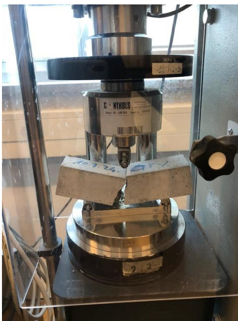
Slika 25. Uređaj za ispitivanje čvrstoće na savijanje
