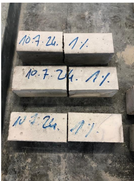
Slika 26. Uzorak nakon ispitivanja čvrstoće na savijanje
