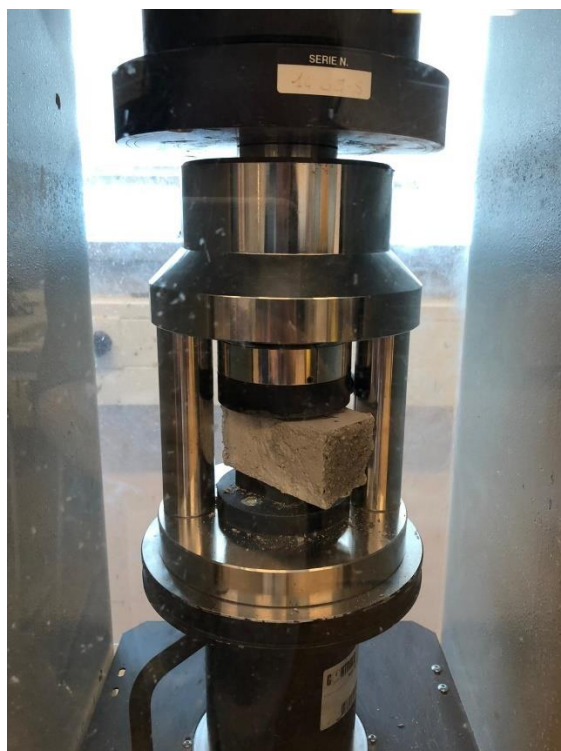
Slika 30. Ispitivanje tlačne čvrstoće
