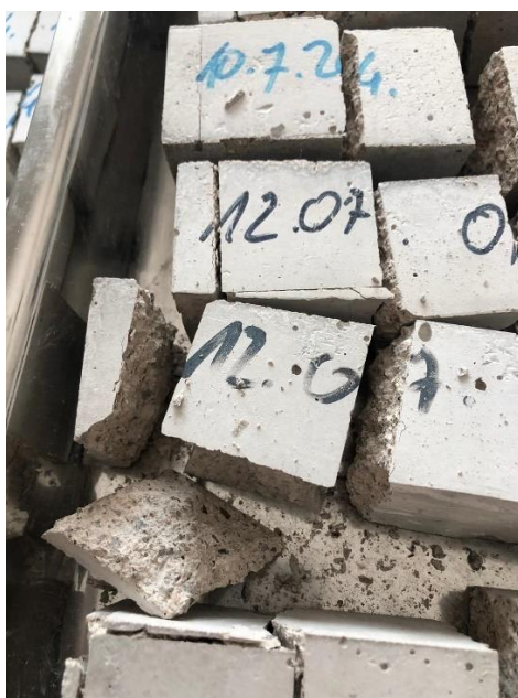
Slika 31. Uzorci nakon ispitivanja čvrstoće na tlak
