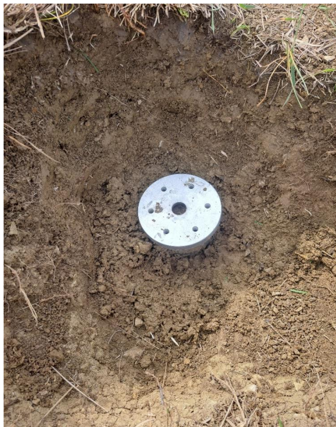
Slika 16. Nabijanje kalupa u tlo
