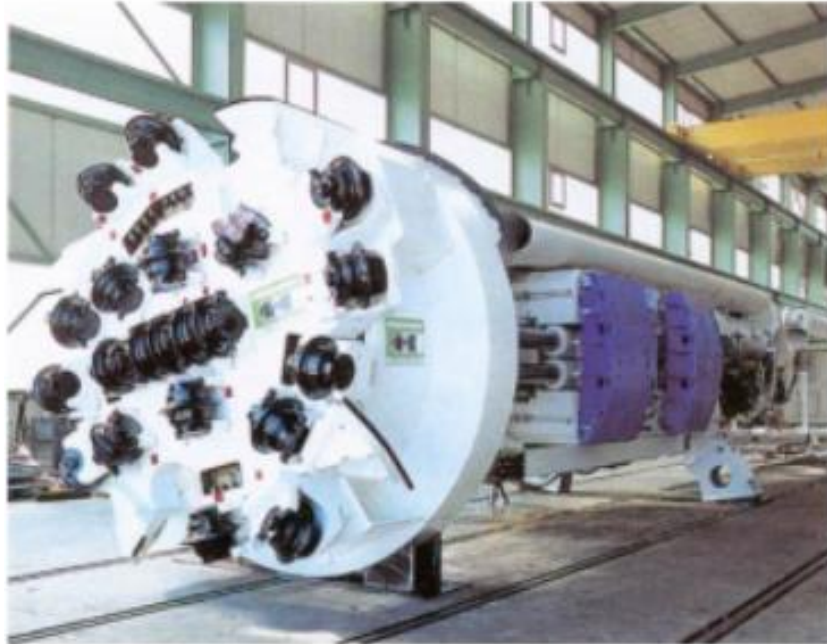
Slika 7 Stroj bez štita [3]
