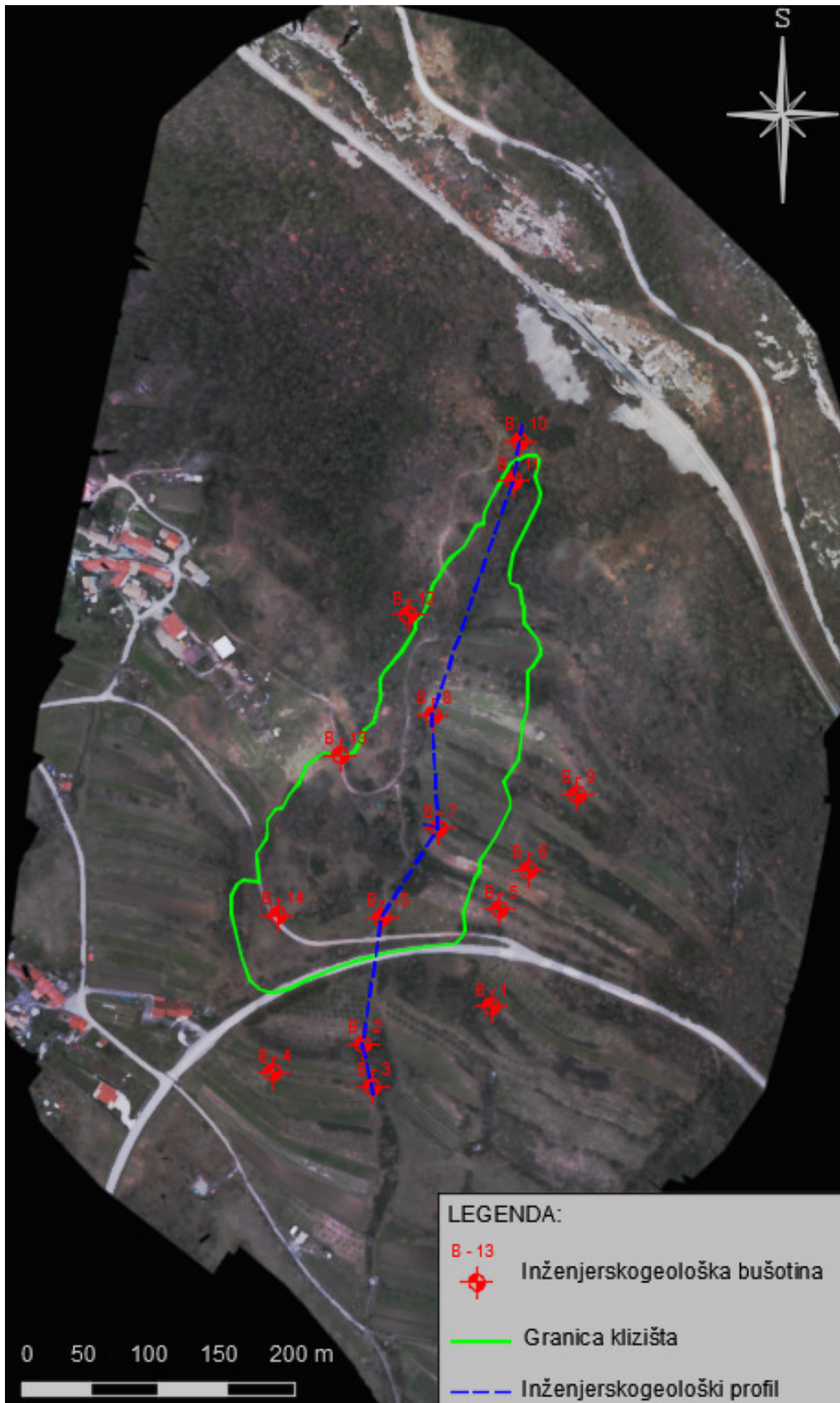
Slika 5.4 Ortofoto karta klizišta Krbavčići II snimljena 2016. godine kombinacijom fotosnimanja iz zraka i terestričkog laserskog skeniranja, s naznačenom granicom klizišta i pozicijama bušotinama izvedenih 1979. godine
