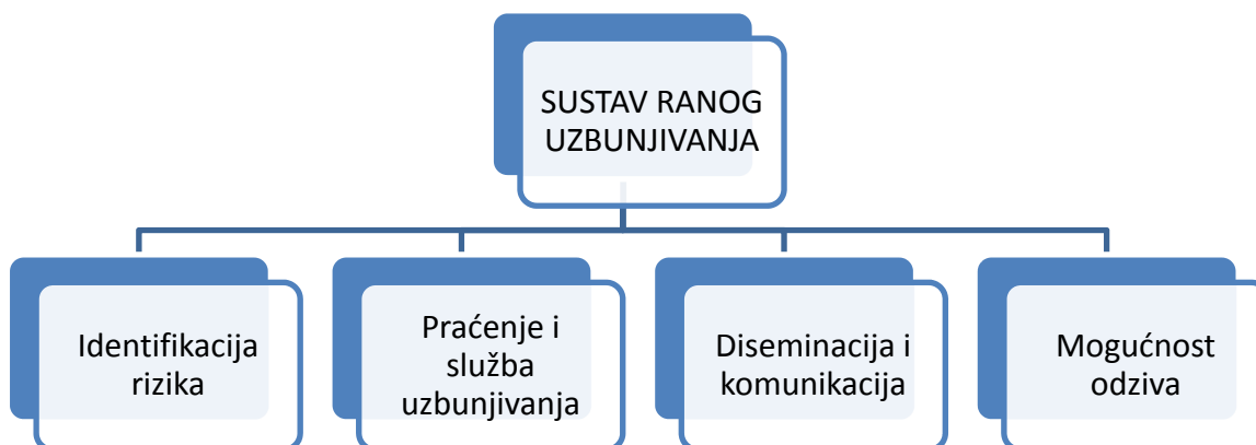
Slika 5. Elementi sustava ranog uzbunjivanja; prikaz izradila: Ivana Sušanjanj prema (UN/ISDR, 2009)
