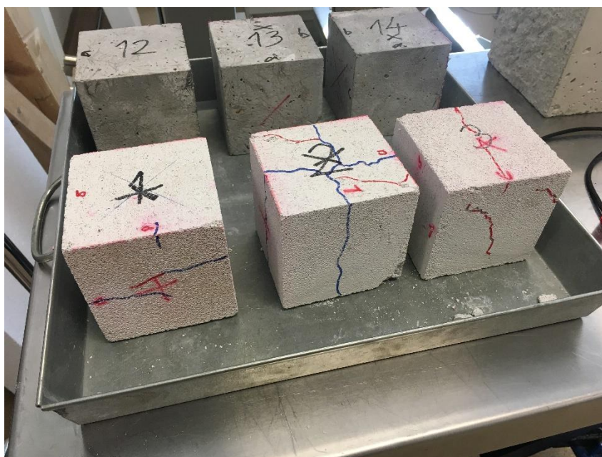
Slika 35: Označene pukotine nakon ispitivanja tlačne čvrstoće betona
