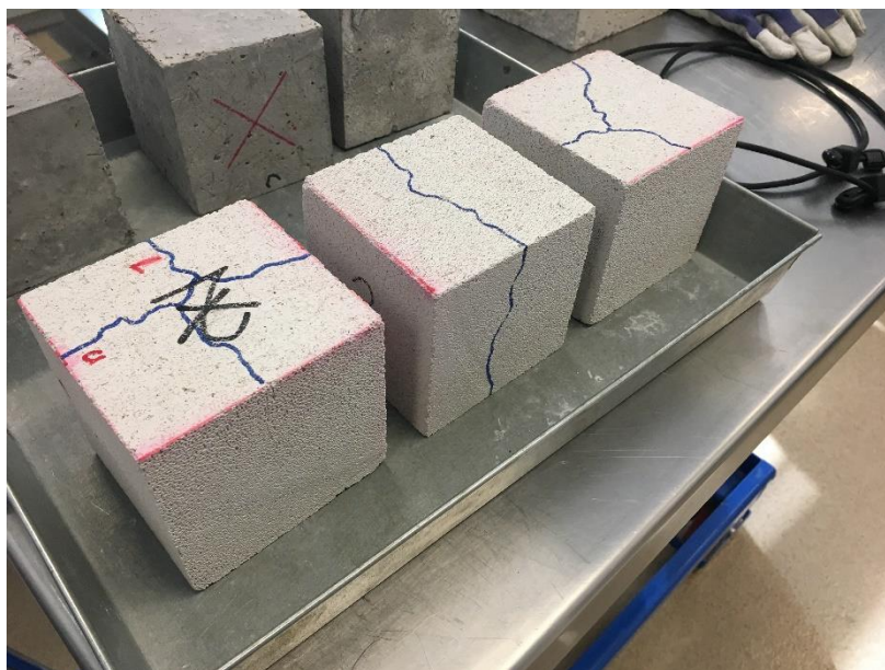
Slika 33: Uzorci porobetona sa iscertanim pukotinama dobivenim sušenjem na prevelikoj temperaturi
