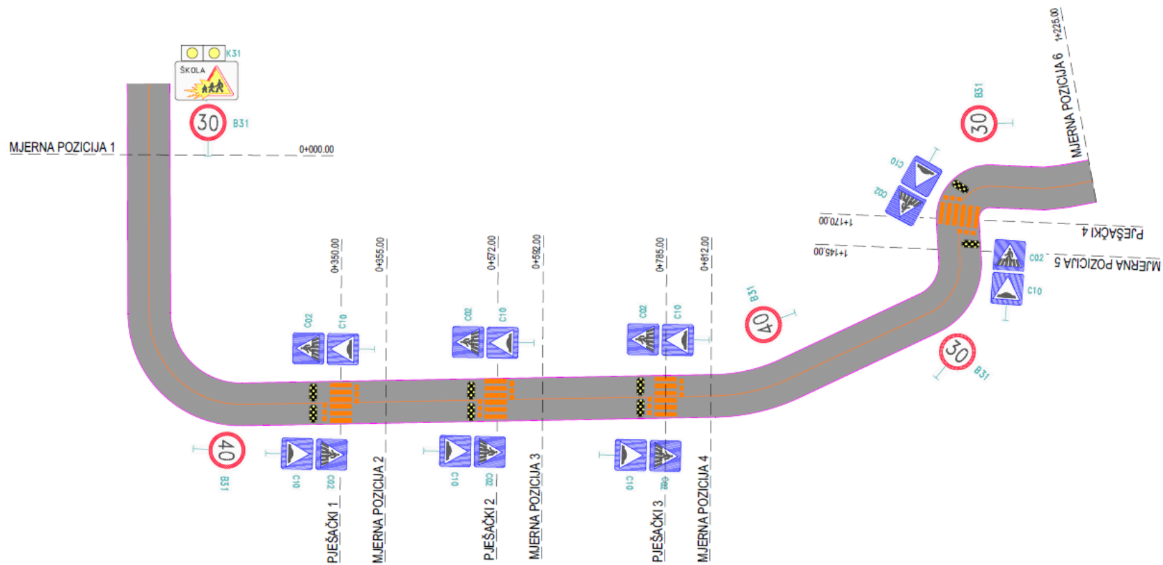
Slika 51. Pozicije postavljanja brojača i lokacije pješačkih prijelaza
