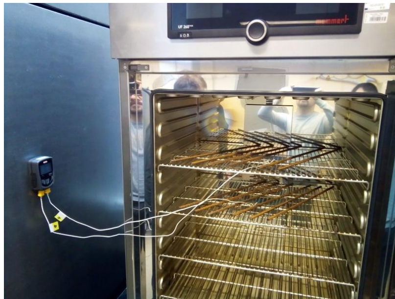
Slika 7. Uzorci spremni za proces umjetnog starenja
