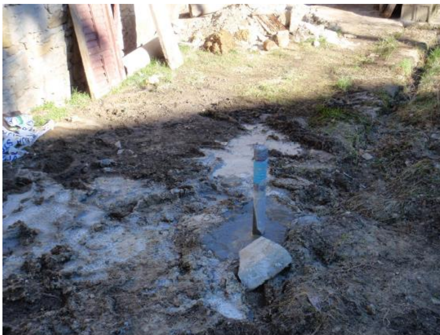
Slika 31. Bušotina B-4 i u nju ugrađen inklinometar (preuzeto iz Bernat, 2011).
