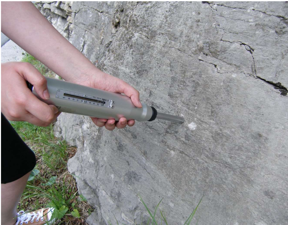
Slika 16. Ispitivanje jednoosne tlačne čvrstoće pomoću Schmidtovog čekića na prometnici E751, Istra.
