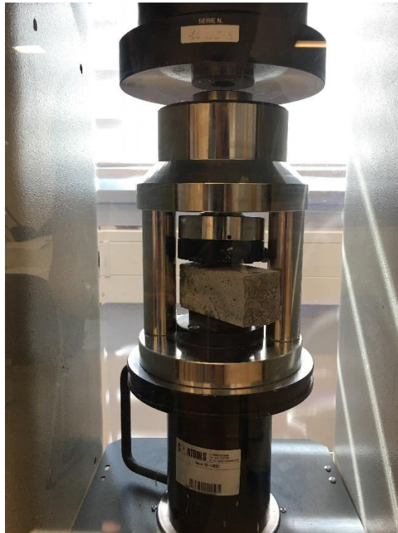
Slika 11. Uređaj za ispitivanje tlačne čvrstoće
