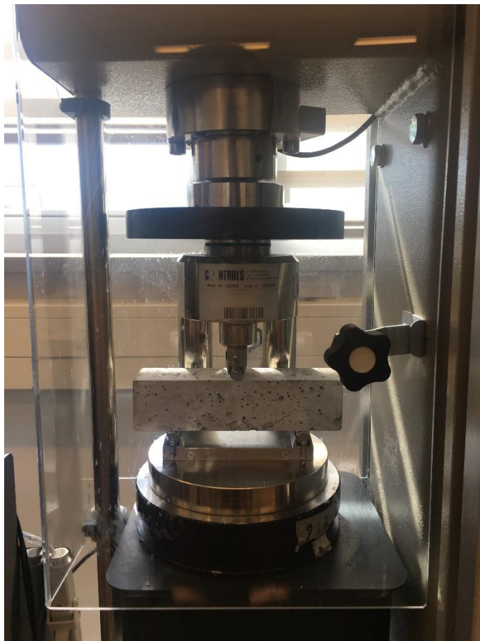
Slika 10. Uređaj za ispitivanje vlačne čvrstoće
