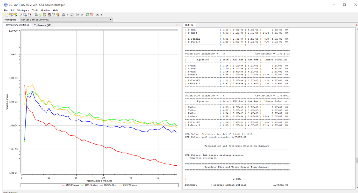
Slika 4.3. Iterativni proces obrade podataka i konvergencija rješenja za numerički model
