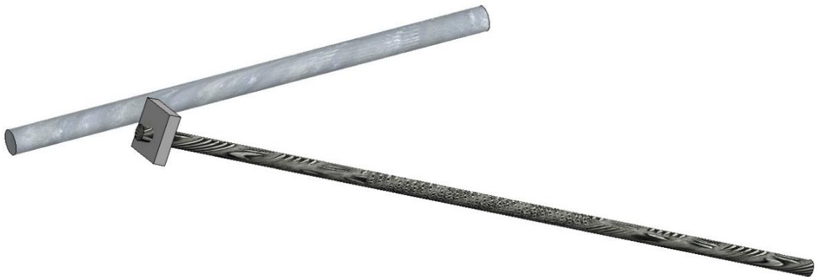
Slika 55. Štapno sidro i procjednica
