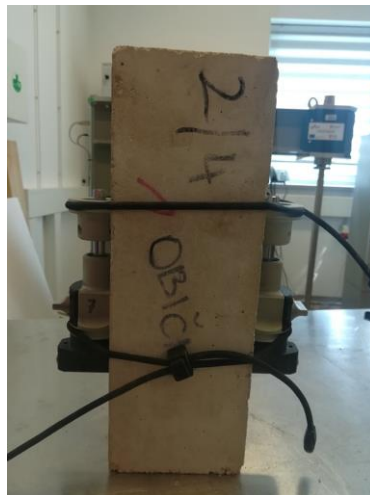
Slika 12: Uređaj za prepoznavanje deformacije s 55-C0222 / F sensorima
