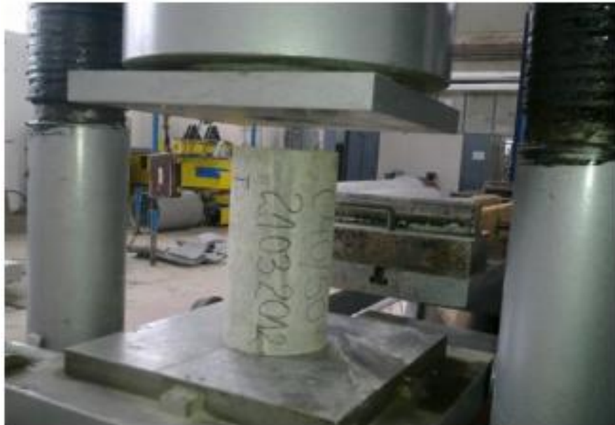
Slika 7: Ispitivanje tlačne čvrstoće na uzorku valjka
