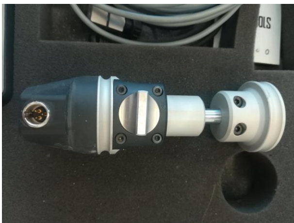
Slika 22: Ekstenziometar, model 55-CO222/F, marka Controls
