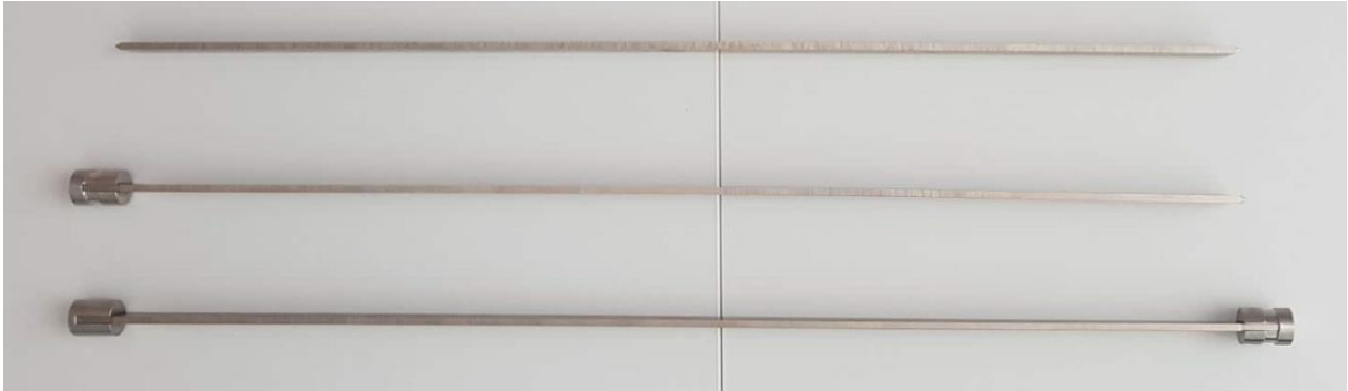
Slika 23. Uzorci za ispitivanje različitih uvjeta oslanjanja
