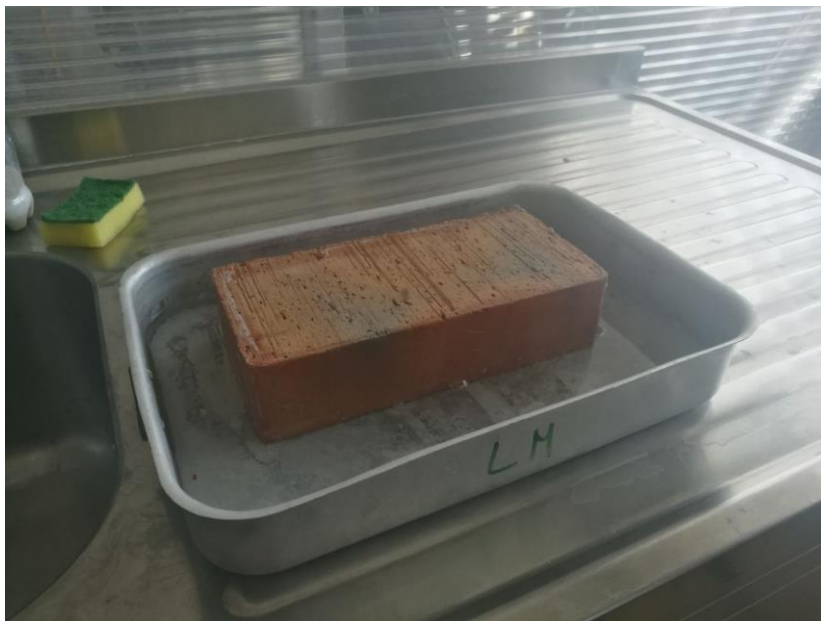
Slika 53: Uzorak opeke umočen u vodu [Ines Šoić]
