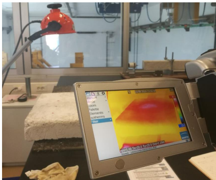
Slika 44: Prikaz temperature materijala na termografskoj kameri [Ines Šoić]
