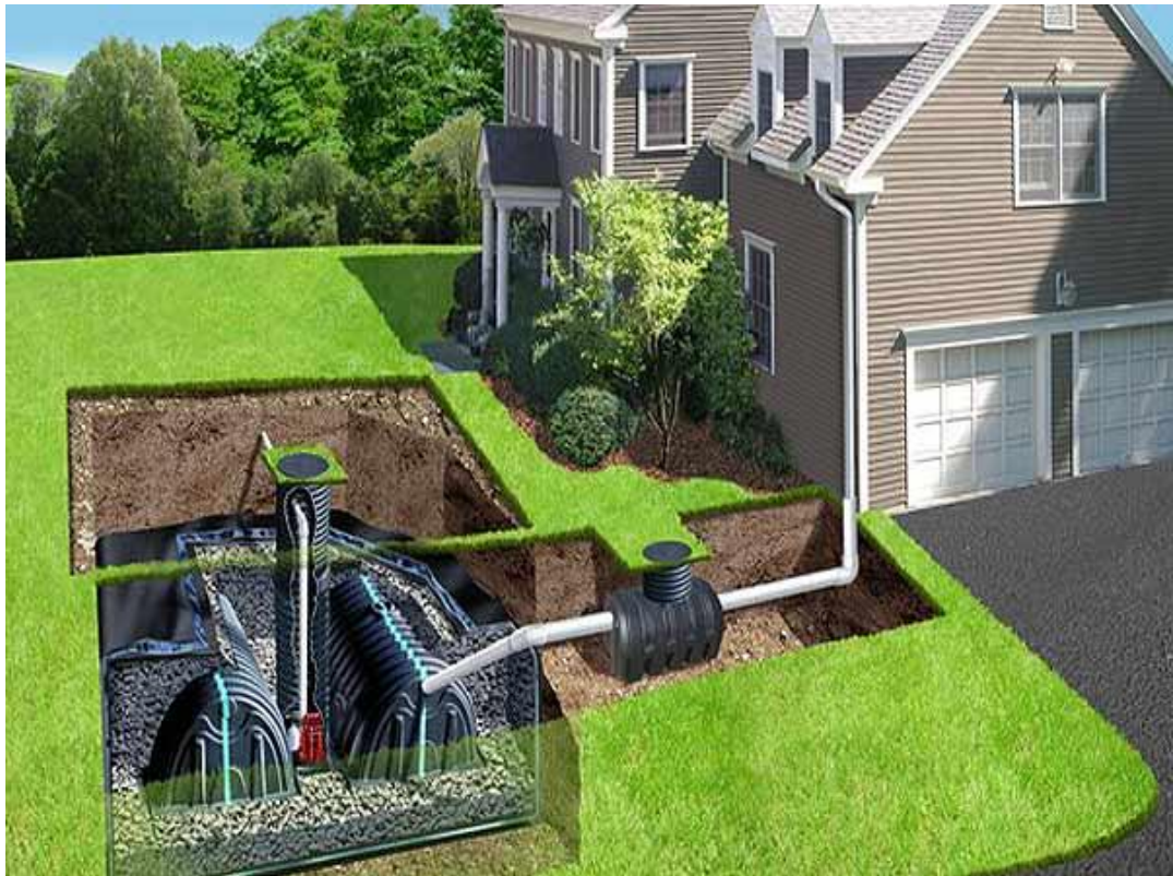
Slika 6 : Podzemni spremnik vode [6]
