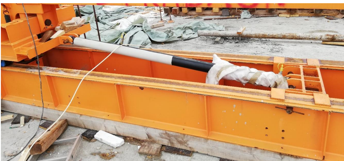
Slika 33: Cilindar za pomicanje krletke (autor: Patricia Blažević)
