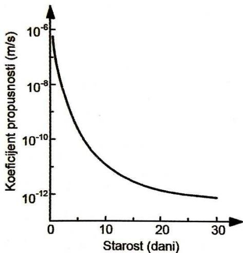
Slika 2. Utjecaj hidratacije na propusnost cementne paste [1]
