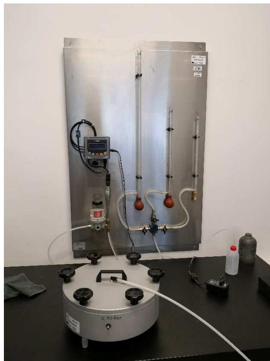
Slika 13. Uređaj za ispitivanje plinopropusnosti
