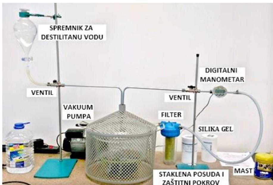
Slika 15. Oprema za saturiranje uzorka [9]
