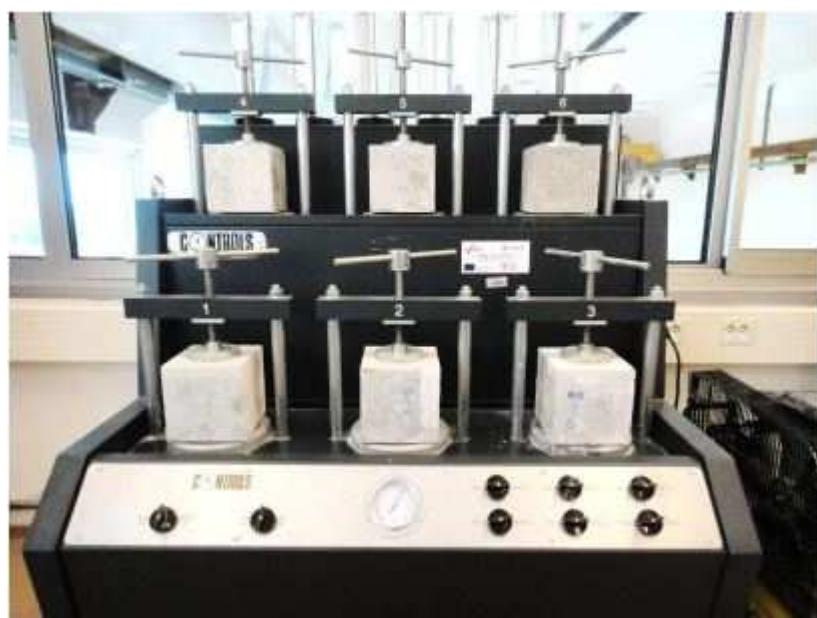
Slika 12. Uredaj za ispitivanje vodopropusnosti [6]
