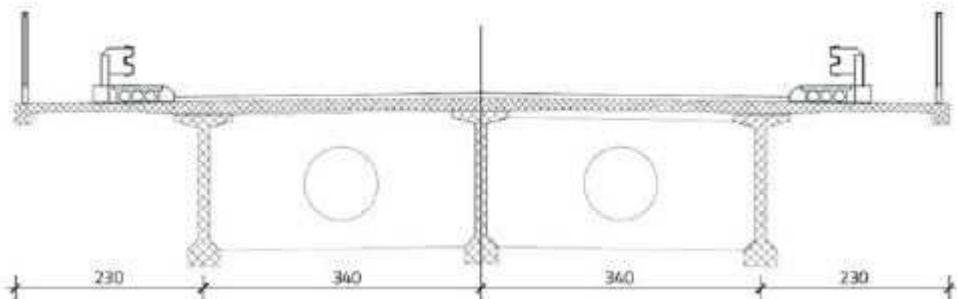
Slika 24. Karakteristični poprečni presjek konstrukcije mosta [13]
