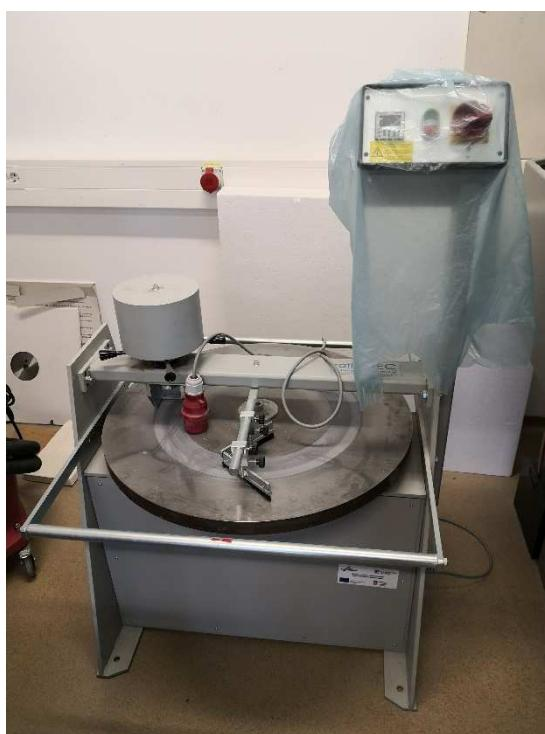
Slika 17. Uredaj za ispitivanje otpornosti na abraziju
