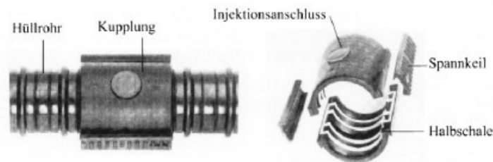
Abbildung 5.11: Kopplung von Hüllrohren [49]
