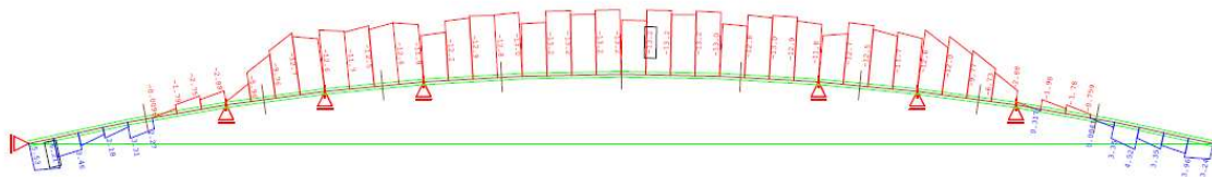
Abbildung 5.7: Spannungen infolge Hebung mit Mobilkran
