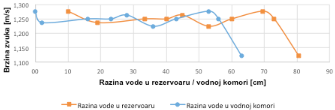
Slika 32. Prikaz odnosa brzine zvuka i razine vode u rezervoaru/vodnoj komori [4]
