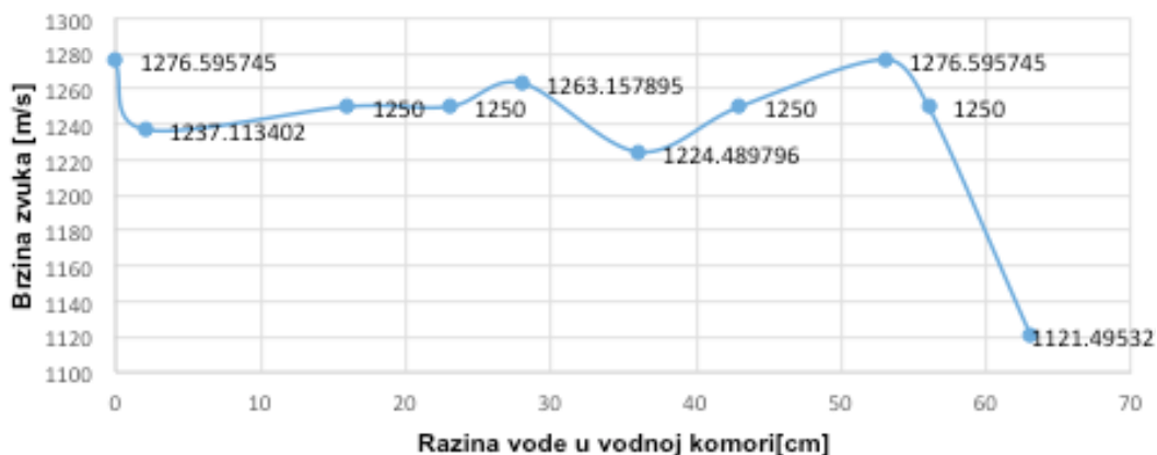
Slika 31. Prikaz odnosa brzine i razine vode u cilindričnoj vodnoj komori [4]
