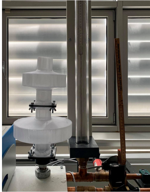
Slika 35. Prikaz raščlanjene (lijevo) i cilindrične vodne komore (desno) [4]
