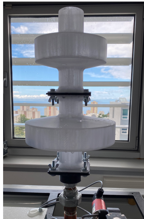
Slika 29. Detalj spoja komore maticama i vijcima (Hidrotehnički praktikuum, Građevinski fakultet u Rijeci) [4]
