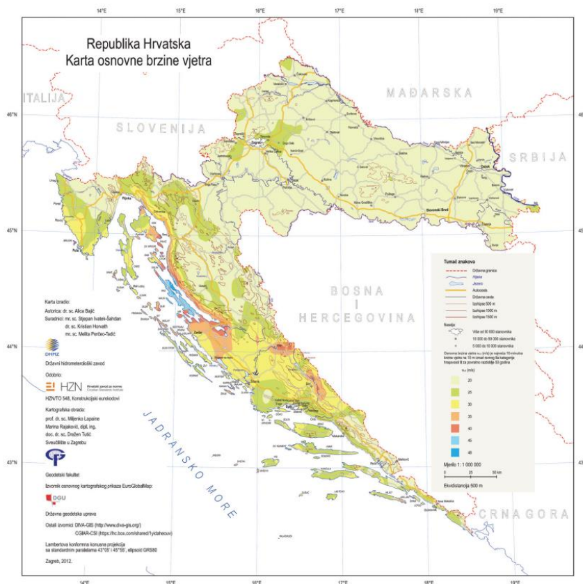
Slika 5: Osnovna brzina vjetra v_{b,0} [4]
