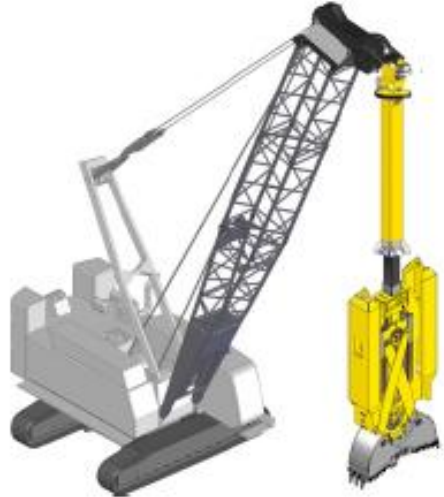
Slika 10. Grabilica za iskop rovova dijafragmi [15].
