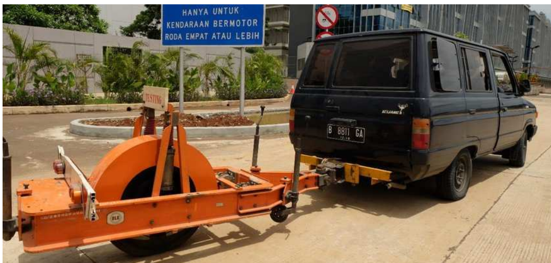
Slika 21. Integrator neravnina (Bump Integrator) ) [1]
