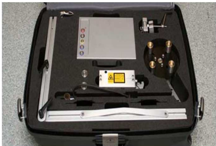
Slika 26. Komplet opreme LaserProf u transportnom kovčegu [27]
