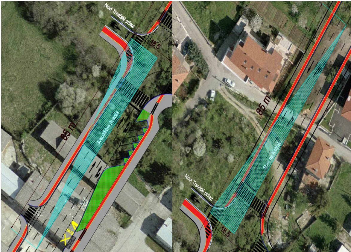
Slika 29: Potrebna preglednost za desno i lijevo skretanje iz Novog Trsatskog prilaza po HRN U.C4.050.
