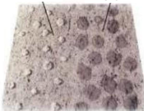
Slika 29: Impregnirani i neimpregnirani dio betona [23]
