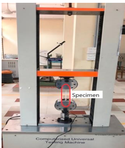
Slika 24: Ispitivanje uzorka na rastezljivost [33]
