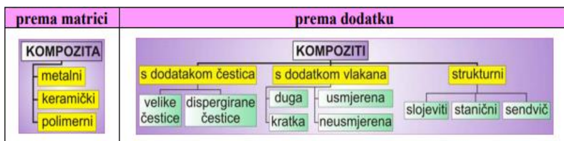
Slika 3: Matrice i pojačanja polimernih kompozita [10]
