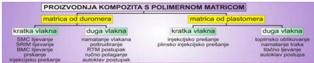
Slika 11: Postupci proizvodnje kompozita [1]
