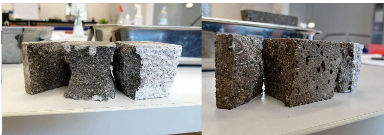
Slika 25. Usporedba uzorka nakon ispitivanja na tlačnu čvrstoću, lijevo bez PVC piljevine te desno sa PVC piljevinom
