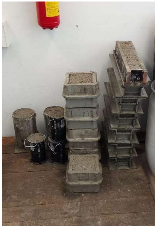
Slika 29. Uzorci nakon ugradnje
