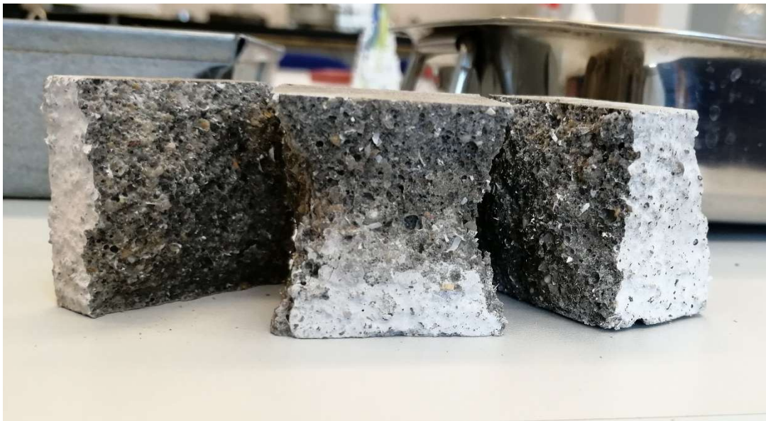
Slika 24. Oblik pješčanog sata nakon sloma uzorka
