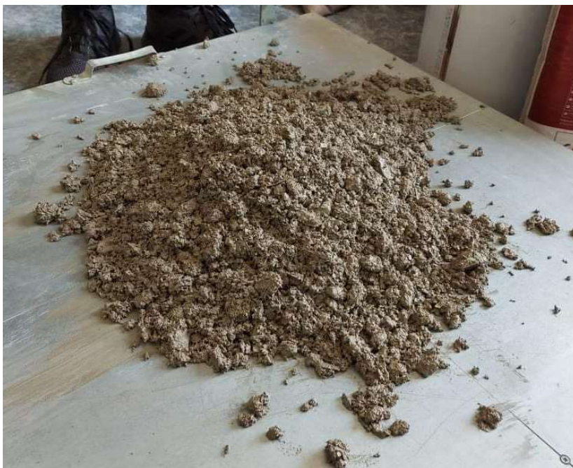
Slika 30. Svježa betonska mješavina nakon ispitivanja rasprostiranjem
