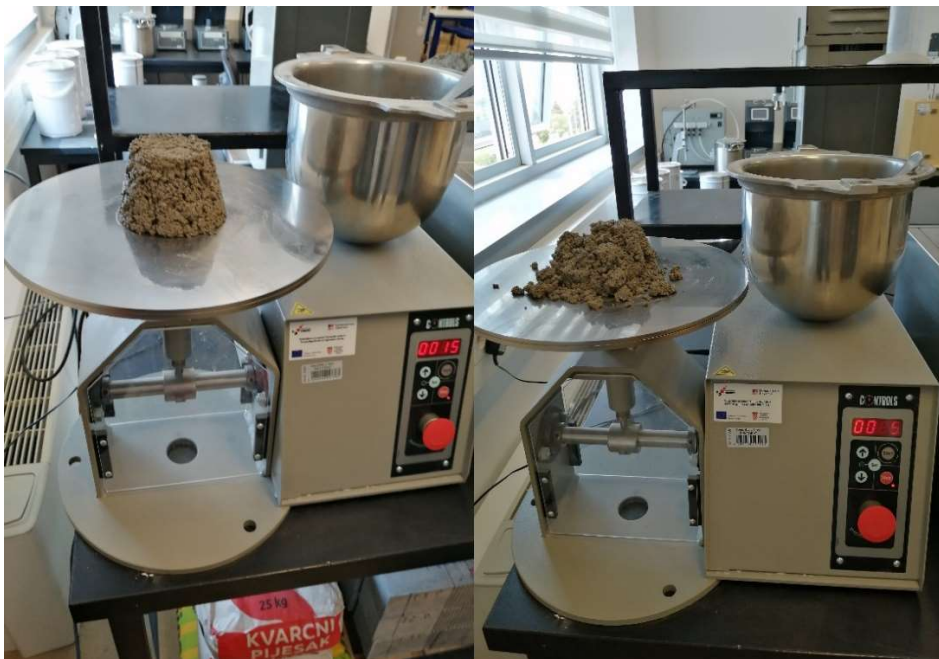
Slika 9. Suha mješavina (gubitak vode)
