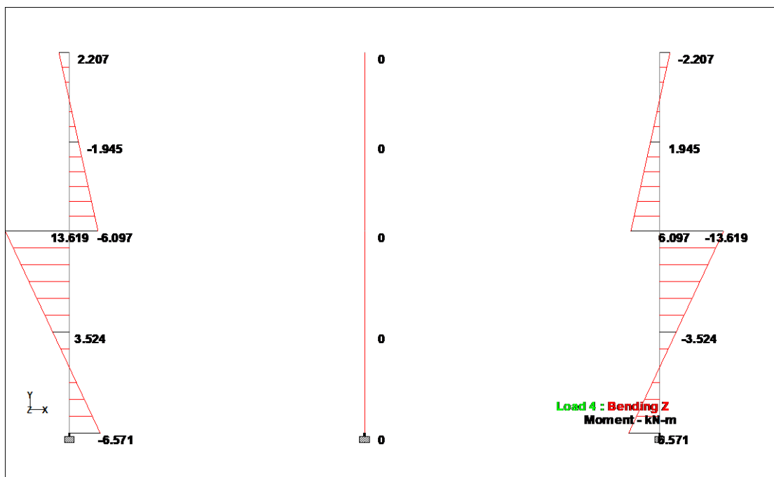
Slika 39: Dijagram momenata savijanja stupova
