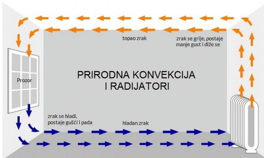
Slika 13: Prirodna konvekcija na primjeru radijatora [11]
