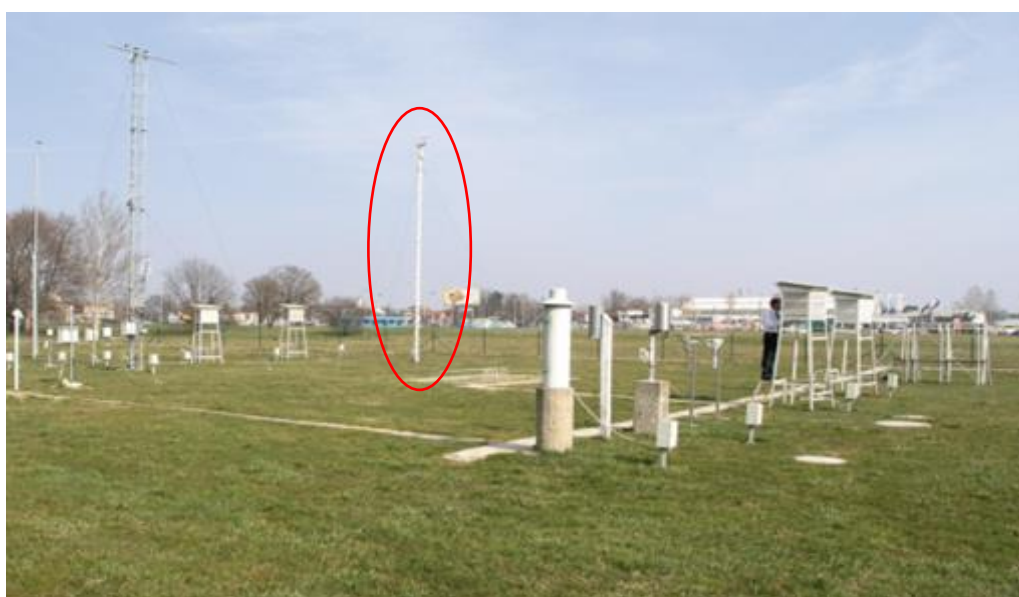
Slika 4. Anemograf na meteorološkoj postaji
