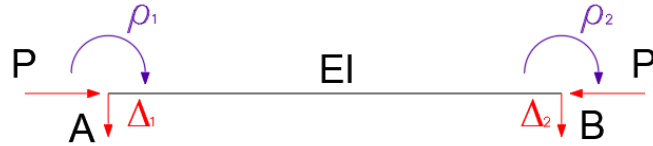
Slika 4.3. Štap s uvedenim pomacima \Delta_1, \rho_1, \Delta_2, \rho_2
