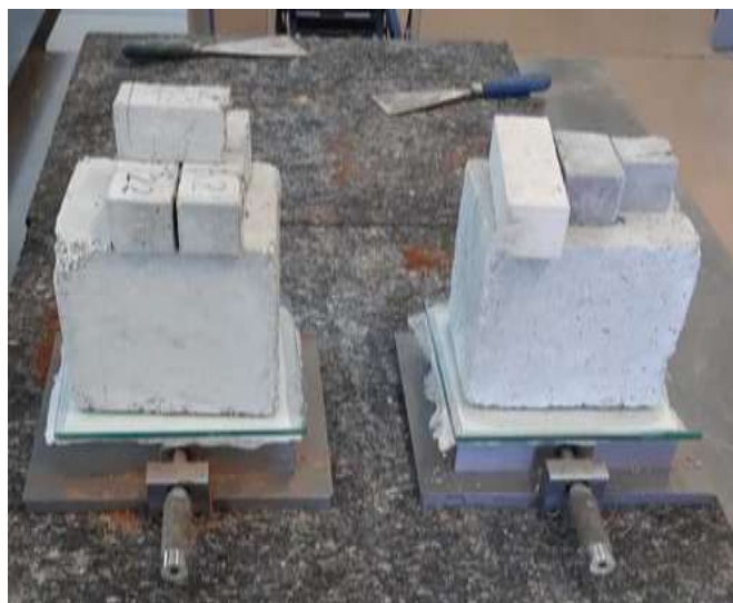
Slika 36 – Uzorci mješavine u kalupu pod opterećenjem
