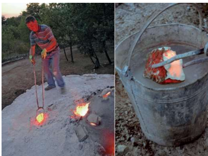
Slika 16 - Ispitivanje pečenosti vršnog kamena (Kapitel d.o.o.)
