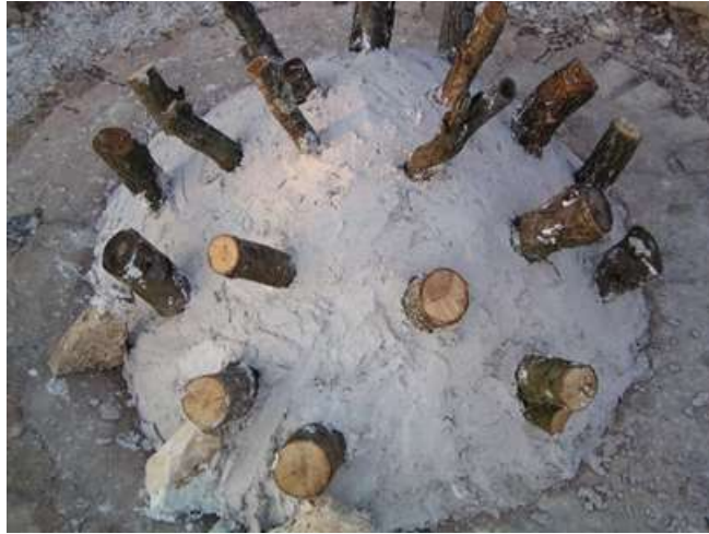
Slika 11 - Ispupčena kupola japlenice sa dimnjacima prije početka paljenja (Kapitel d.o.o.)
