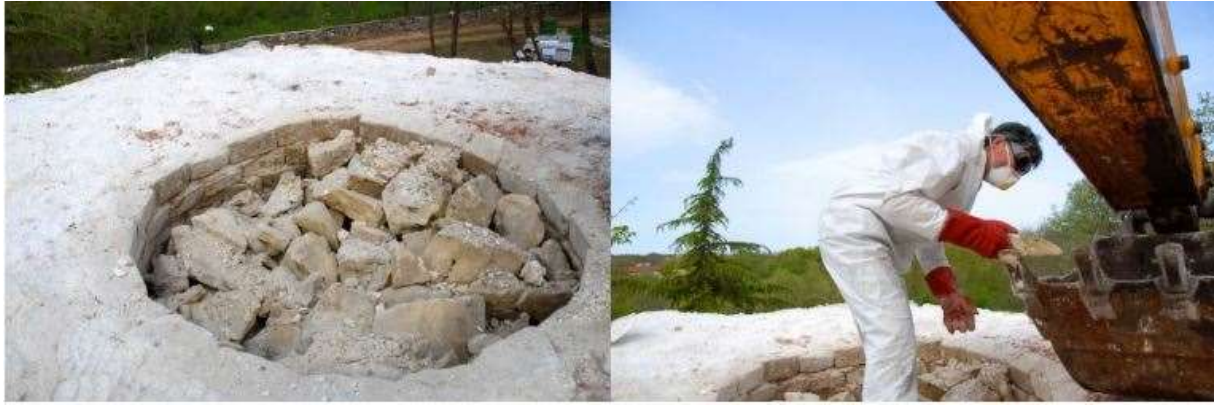
Slika 18 – vađenje živog vapna iz japljenice (Kapitel d.o.o.)
