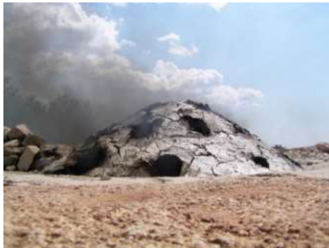
Slika 15 - Vrh japlenice pri kraju paljenja (Kapitel d.o.o.)
