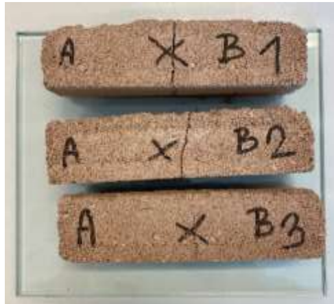
Slika 40 – Uzorci nakon ispitivanja savojne čvrstoće s vidljivim lomom po sredini
