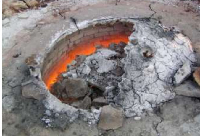
Slika 17 - Vrh japlenice na kraju paljenja (Kapitel d.o.o.)
