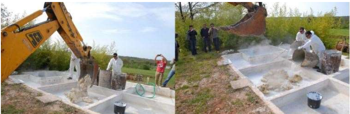
Slika 19 – Postavljanje živog vapna u kade za gašenje (Kapitel d.o.o.)
