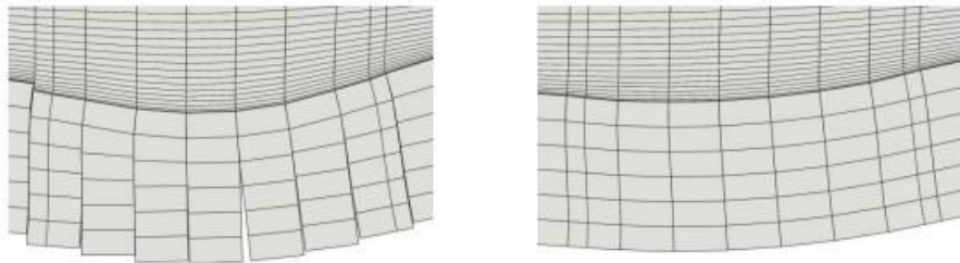
Slika 92: a) Otvaranje i klizanje lamela na dnu presjeka za nelinearnu analizu. b) Linearna analiza – bez otvaranja i klizanja lamela[13]
