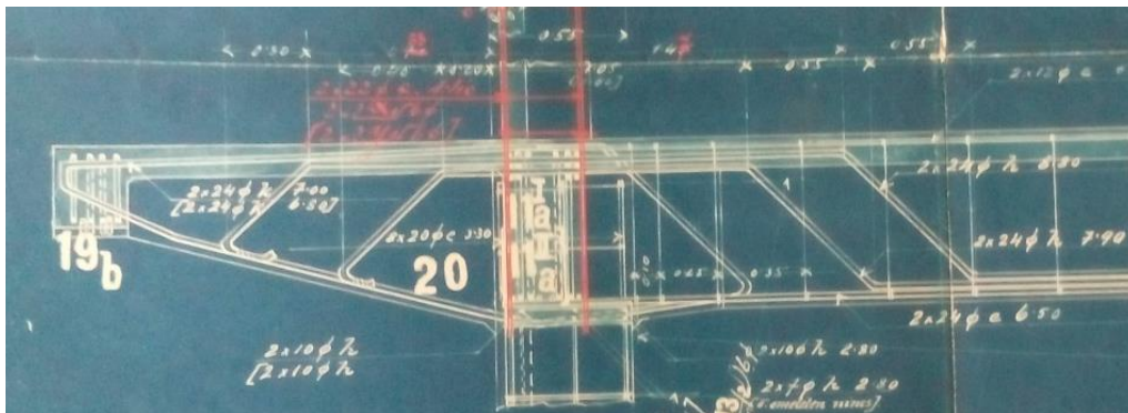
Slika 25: Prikaz armature za gređu poz. 216 [ 7 ]
