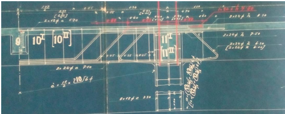
Slika 26: Prikaz armature za gređu poz.217 [ 7 ]
