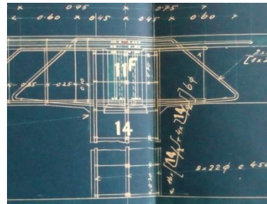
Slika 40: Prikaz armature u stupu S202 [ 7 ]
