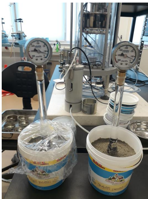
Slika 32: Preliminarni pokusi za određivanje adsorpcijske i desorpcijske grane krivulje retencije standardnim T1 tenziometrima
