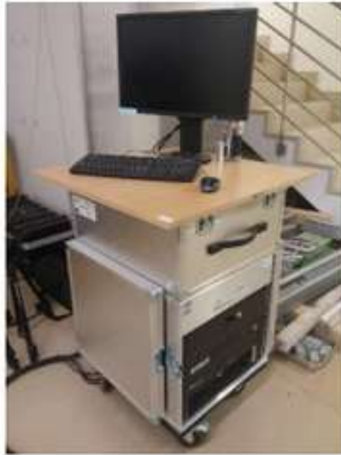
Slika 16: Upravljačka jedinica s GOM programskim paketima Aramis i Pontos
