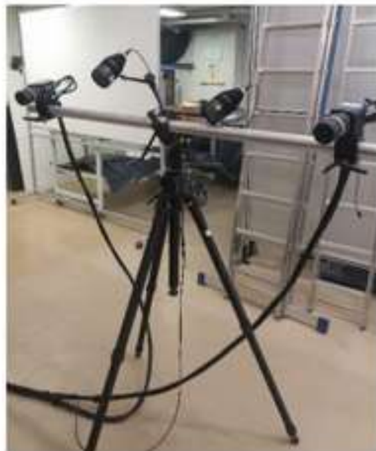
Slika 15: Optički mjerni sustav GOM mbH PONTOS 3D 4M
