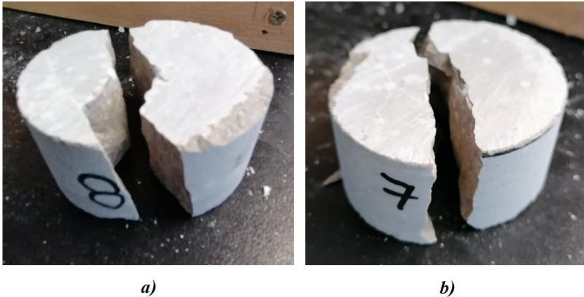
Slika 15: Fotografije a) i b) predstavljaju uzorke aksijalnog pokusa, nakon sloma
